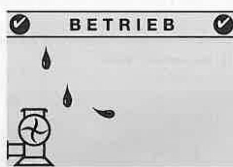
Auf dem Grafikdisplay wird der Sammelschacht mit der Hilfe von Piktogrammen dargestellt. Der Betrachter erkennt, was im Verborgenen vor sich geht ohne den Schacht zu öffnen.
