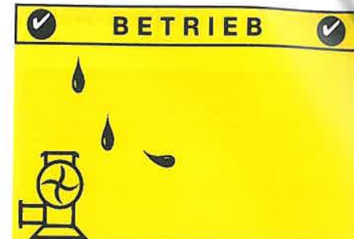
Bild 4: Auf dem Grafikdisplay wird der Sammelschacht mithilfe von Piktogrammen dargestellt. Der Betrachter erkennt, was im Verborgenen vor sich geht, ohne den Schacht zu öffnen.
